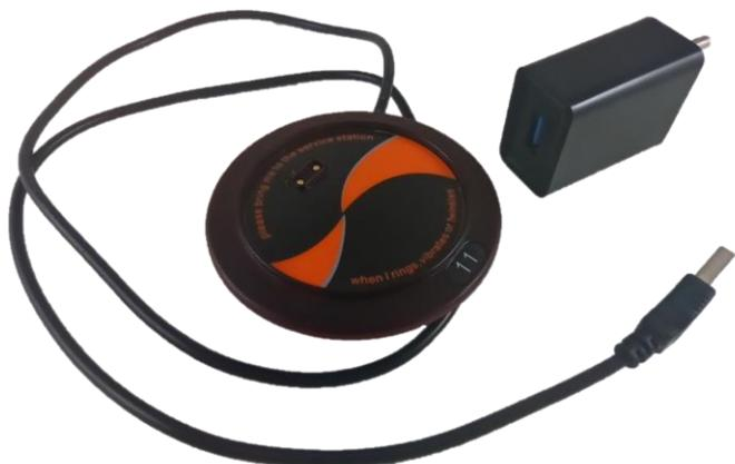
Установите пейджер на зарядную станцию так, что бы совпали контакты. засветится красный светодиодный индикатор означающий, что приемник включен и находится в режиме заряда.
